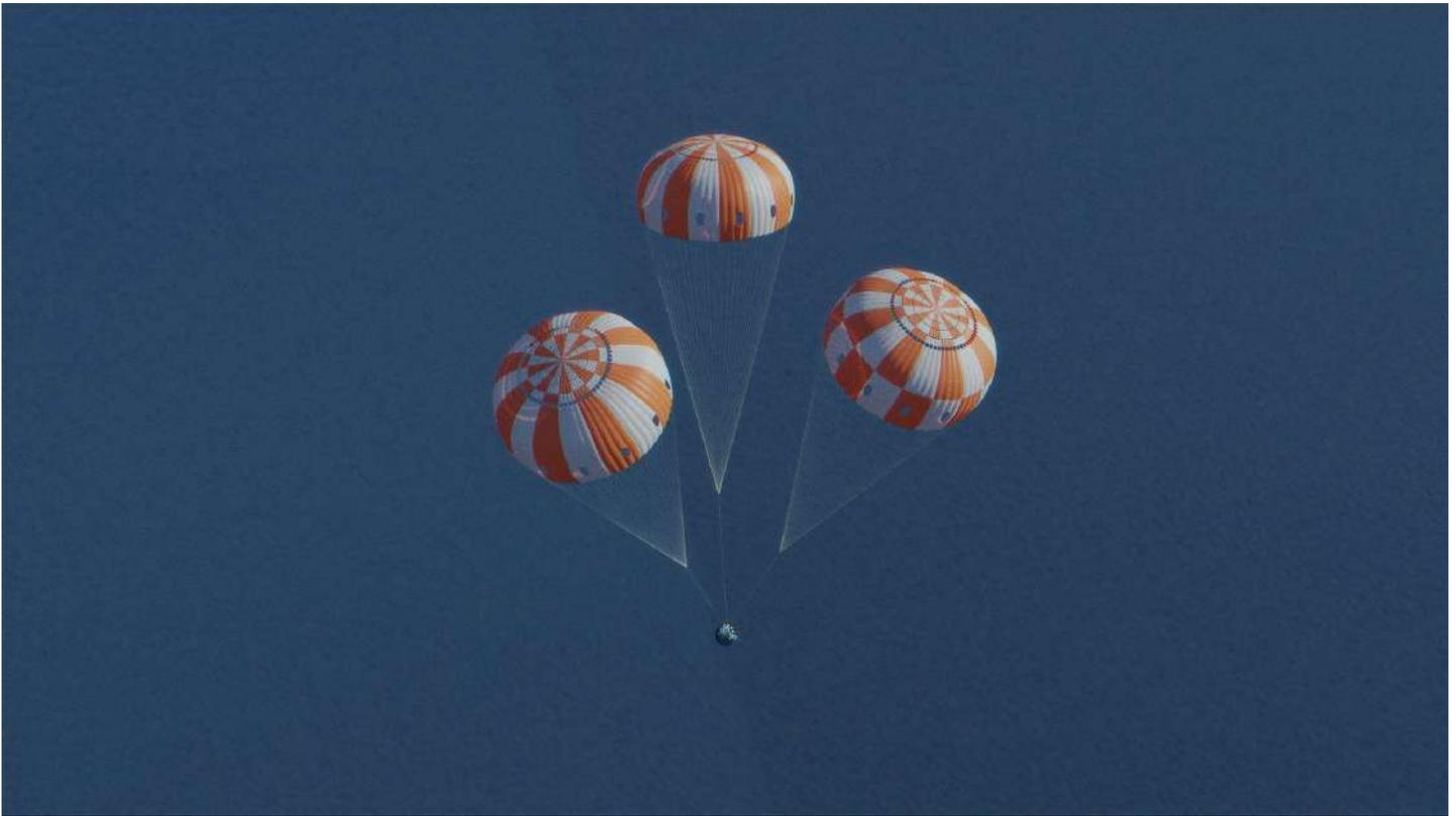
A missão terminará com um teste da capacidade da Orion de retornar com segurança à Terra. Orion entrará na atmosfera da Terra viajando a cerca de 40.000 km/h. A atmosfera da Terra desacelerará a espaçonave a uma velocidade de cerca de 300 mph (480 km/h), produzindo temperaturas de aproximadamente 5.000 graus Fahrenheit (2.800 graus Celsius) e testando o desempenho do escudo térmico.
