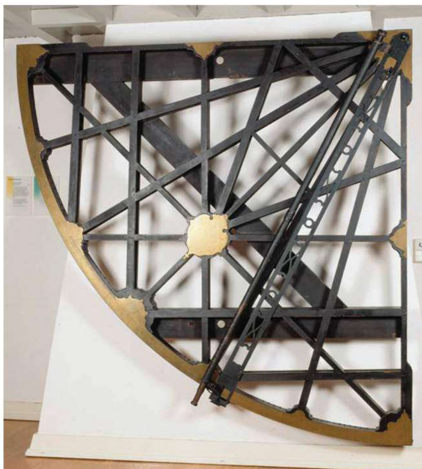
Figura 2. O quadrante usado por Marcgrave em Leiden preservado no Museu Boerhaave. A luneta foi um melhoramento posterior (Museu Boerhaave, Leiden)
