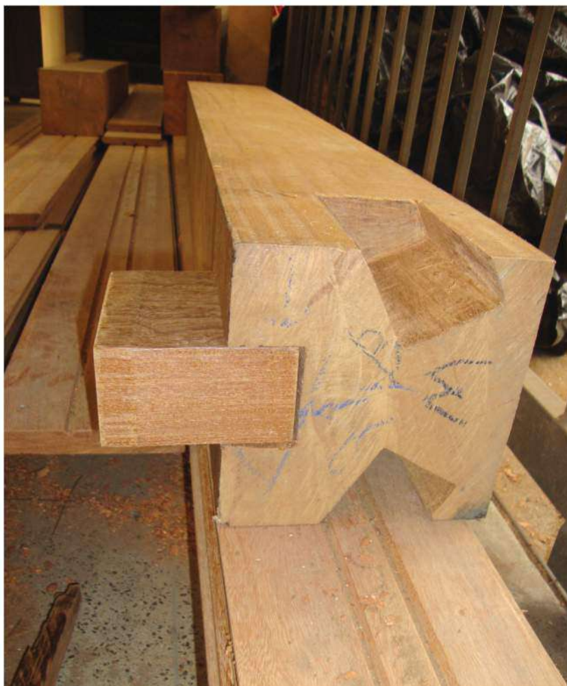
Figura 8. Detalhe em marcenaria referente aos pilares de apoio da base hexagonal do quadrante.
